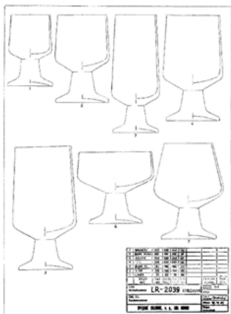
Obr. 8. Návrh kalíškov LR 2039 pre strojovú výrobu, návrh J. Taraba, 1985. Archív RONA, a. s. Lednické Rovne.
